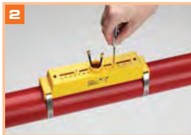
2 Fissare con fascette sul tubo l'assemblaggio guida e sensore e rilasciare le viti di bloccaggio del sensore dopo la regolazione
