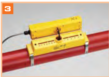
3 Collegare l'alimentazione e i sensori all'assemblaggio elettronico
